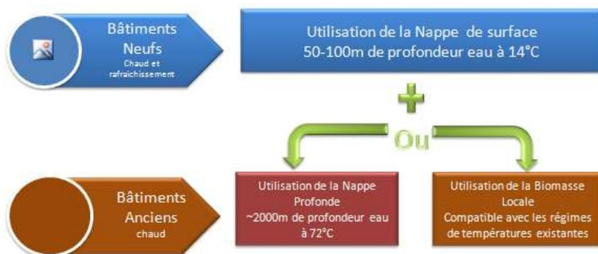
Figure 119 : Raccordement de bâti neuf ou ancien au chauffage biomasse
