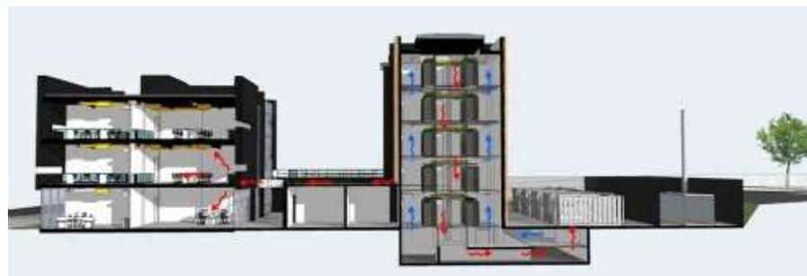
Figure 121 : principe de récupération des calories d'un datacenter pour chauffer un bati (source : ADEME)
